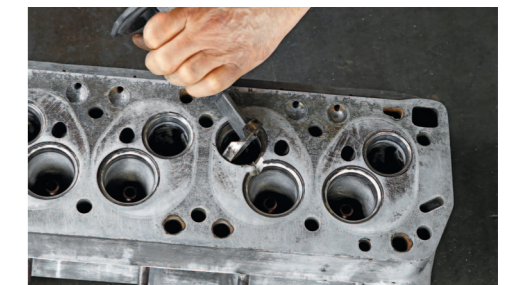
Der Riss ist aufgeschliffen, der Ventilsitzring wird später natürlich erneuert
