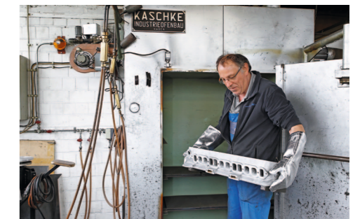
Um ein Verziehen zu verhindern, wird der Kopf vor dem Schweißen thermisch vorbehandelt
