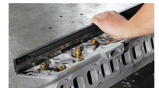
Kontrolle auf Verzug, durch Planrichten lässt sich die Verformung rückgängig machen
