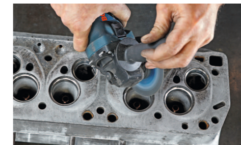
Vorhandene Risse im Zylinderkopf werden mit der Flex gnadenlos ausgeschliffen
