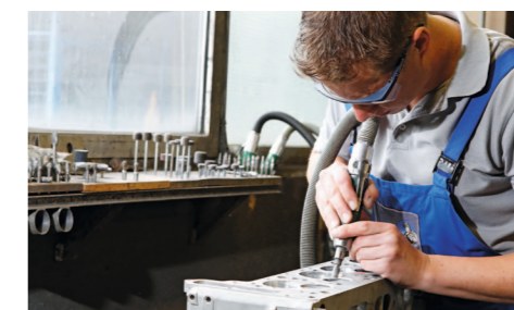
Beim Schweißen wird Material aufgetragen, das muss sauber verschliffen werden
