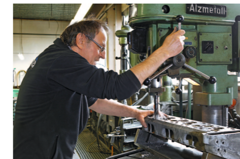
Korrosionsspuren, etwa im Bereich von Wasserkanälen, werden weggefräst
